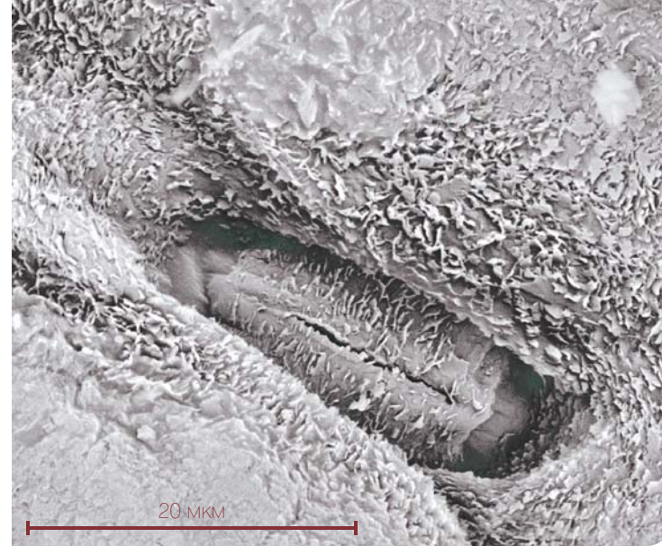
Изображение устьица — мельчайшего отверстия на поверхности листа растения — получено на сканирующем электронном микроскопе TM-1000 (Hitachi), пространственное разрешение которого составляет 30 нм
