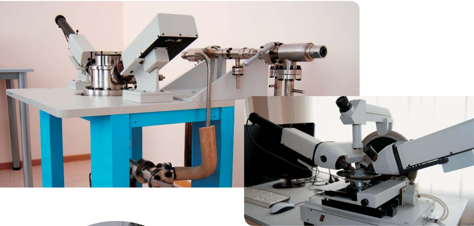
Лазерные эллипсометры используются в исследованиях тонких поверхностных слоев — от полупроводников до живых клеток
