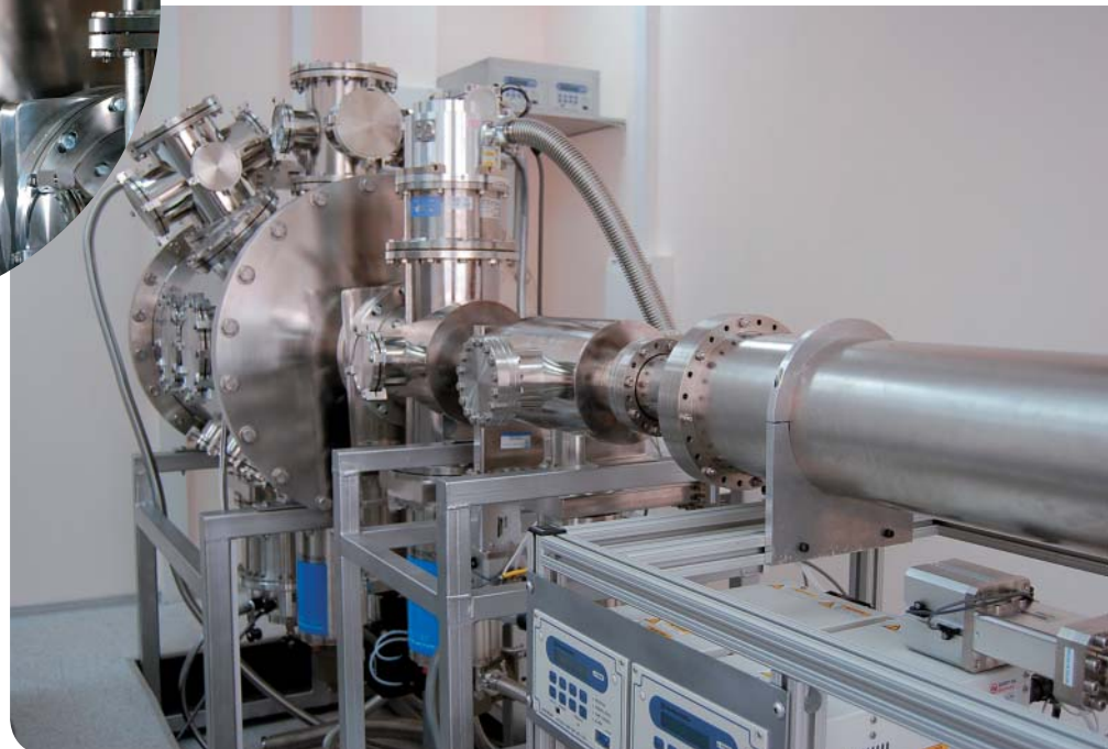
На газодинамическом вакуумном стенде-ЛЭМПУС-2 ведутся исследования плазмохимических процессов и генерации кластеров
