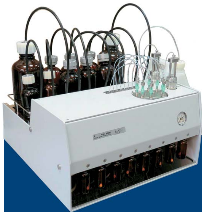
Синтезатор нуклеиновых кислот ДНК и РНК ASM-800ET, разработанный ООО «БИОССЕТ». Этот эффективный прибор долгое время обеспечивал потребности российских организаций в олигонуклеотидах, а также поставлялся в 26 зарубежных стран, главным образом в США
