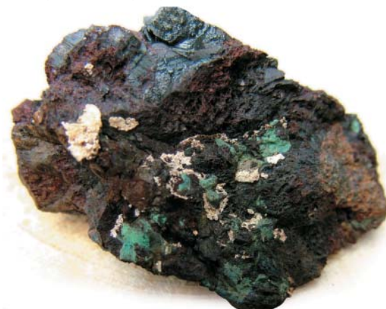
Образец карбонатно-фрейбергитовой окисленной руды. На малахите и карбонате – пластинки самородного серебра
