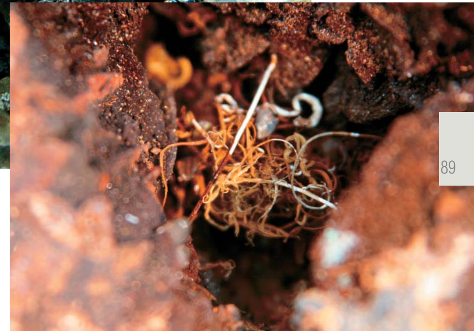
Проволоки самородного серебра, покрытые гидроксидами железа в друзе окисленного сидерита
