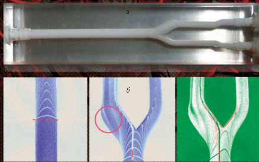
Специалисты из ИЦИГ СО РАН совместно с Международным томографическим центром СО РАН проводят эксперименты на физической модели сонной артерии, созданной в соответствии с физиологическими параметрами компанией Shelley Medical Imaging Technologies (а). Изучение динамики намагниченных слоев жидкости в области бифуркации (б) позволяет обнаружить застоные зоны, представляющие опасность с медицинской точки зрения, так как в них может образоваться тромб
