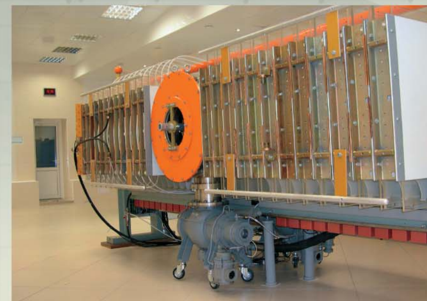
В ИСЭ СО РАН готовится к запуску лазерная система субпетаваттной мощности с длительностью импульса 10^{-14} с. На снимке – выходной усилитель с газовой активной средой
