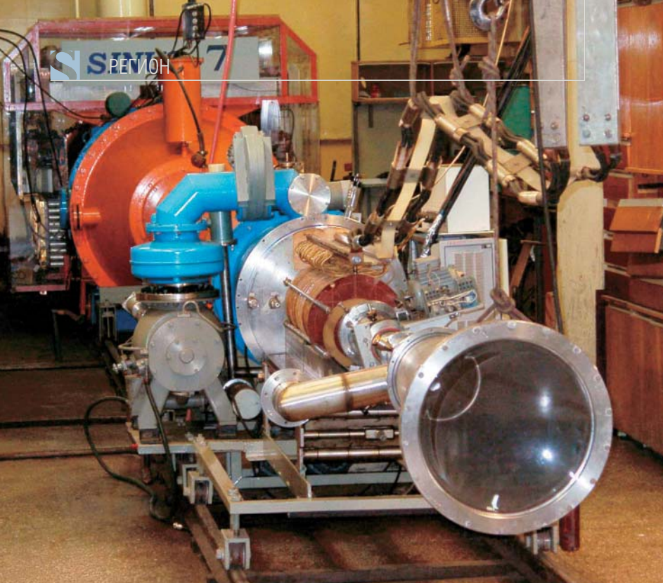
Генератор гигаваттных СВЧ-импульсов на основе сильноточного ускорителя электронов СИГУС-7. Поля излучения таких генераторов легко вызывают пробой воздуха, заставляют вспыхивать обесточенные лампы дневного света и успешно выводят из строя оставленные в лаборатории сотовые телефоны, калькуляторы, цифровые фотоаппараты
