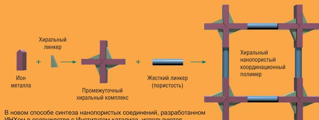
В новом способе синтеза нанопористых соединений, разработанном ИНХом в содружестве с Институтом катализа, используются два линкера, один из которых (искусственно синтезируемый) обеспечивает структуре пористость, а другой (природные кислоты: аскорбиновая, винная, молочная, лимонная и др.) придает хиральность
