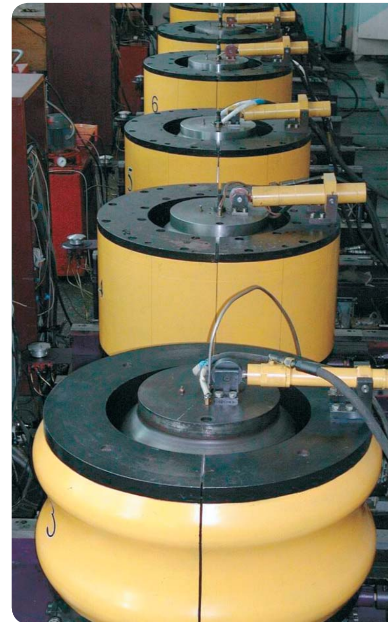
Многопуансонные аппараты «разрезная сфера»
