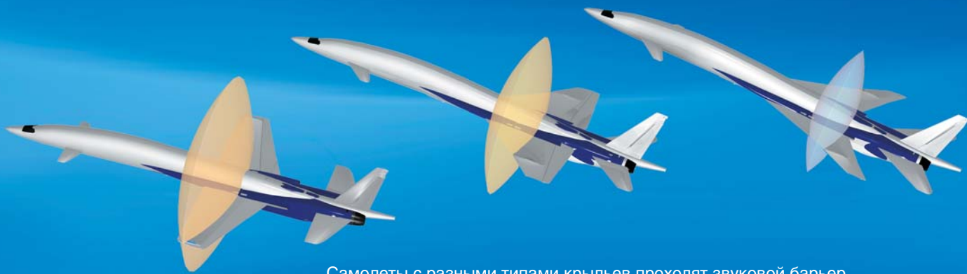
Самолеты с разными типами крыльев проходят звуковой барьер. Хорошо виден скачок давления при переходе от сверхзвукового потока к дозвуковому, при этом область скачка имеет минимальные размеры при стреловидной форме крыла
