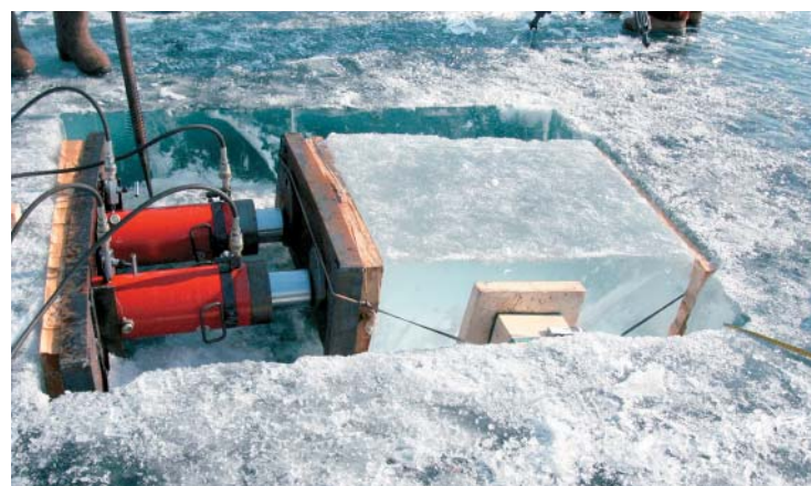
Сотрудниками Института земной коры СО РАН (г. Иркутск) и Института физики прочности и материаловедения СО РАН (г. Томск) на ледовом полигоне Байкала ведутся многолетние исследования по моделированию сейсмических процессов с целью разработки технологий управления землетрясениями
