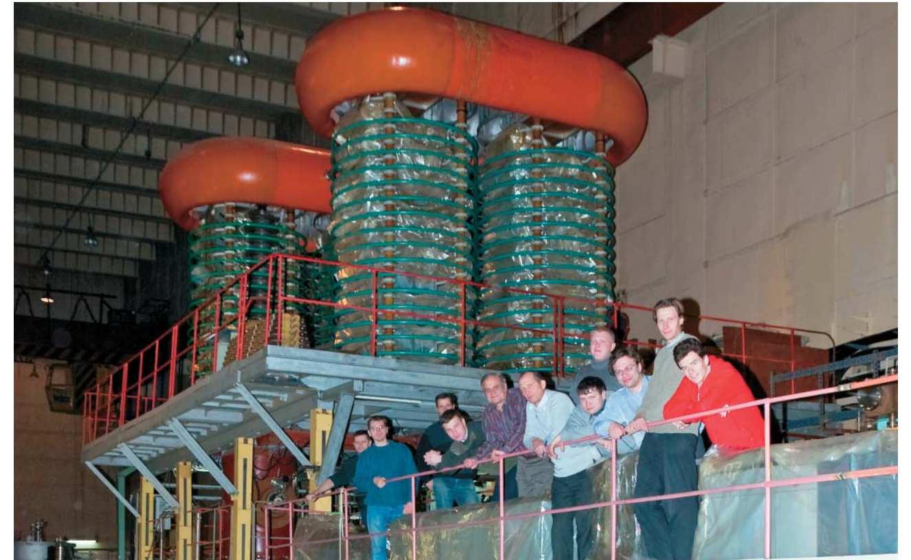
Генератор мегавольтных импульсов ускорителя У-2, используемого для нагрева плазмы в многопробочной ловушке ГОЛ-3
