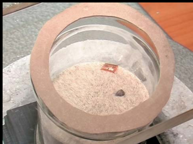
1 мин 54 с, частота колебаний 100 Гц: на поверхности движущегося песка медная пластинка и зерно вольфрамита
