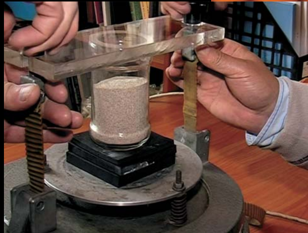
51–53 с, частота колебаний 50 Гц: на поверхности песка зерно граната и угловатое зерно пикроильменита
