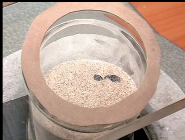
1 мин 54 с, частота колебаний 100 Гц: на поверхности движущегося песка медная пластинка и зерно вольфрамита
