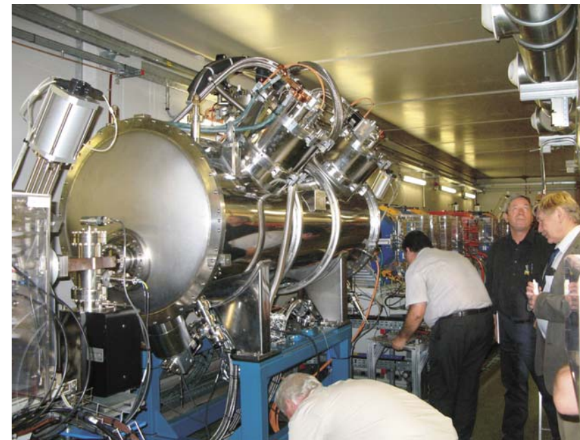
В центре синхротронного излучения ALBA CELLS (Испания) запускается в эксплуатацию 119-полюсный сверхпроводящий вигглер, разработанный и созданный в новосибирском Институте ядерной физики СО РАН. Фото автора
